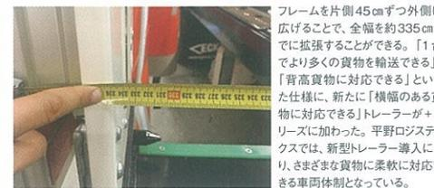
フレームを片側45cmずつ外側に広げることで、全幅を約335cmまでに拡張することができる。「1台でより多くの貨物を輸送できる」、「背高貨物に対応できる」といった仕様に、新たに「横幅のある貨物に対応できる」トレーラーが+1シリーズに加わった。平野ロジスティクスでは、新型トレーラー導入により、さまざまな貨物に柔軟に対応できる車両体制となっている。
