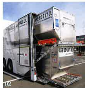
01. 車両の高さ制限を守るため低床に。トラックには「JL9950」のように飛行機と同じく、便名が付いている。02. 上下二段にコンテナを積める構造に。
