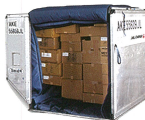
▲写真左上がLD7パレットタイプ、右がLD3コンテナタイプのサーマルブランケット
